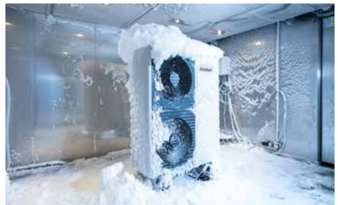
Camerele climatice simulează toate condițiile de funcționare posibile
